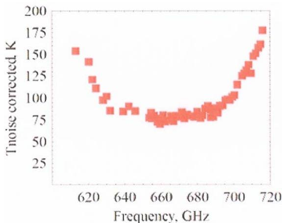
FIG. 5: TYPICAL NOISE-PERFORMANCE OF ONE OF THE 660GHZ MIXER DEVICES VERSUS RF-TUNING RANGE
