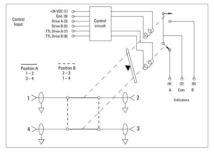
Figure 1. Agilent 87222C/D/E schematic
